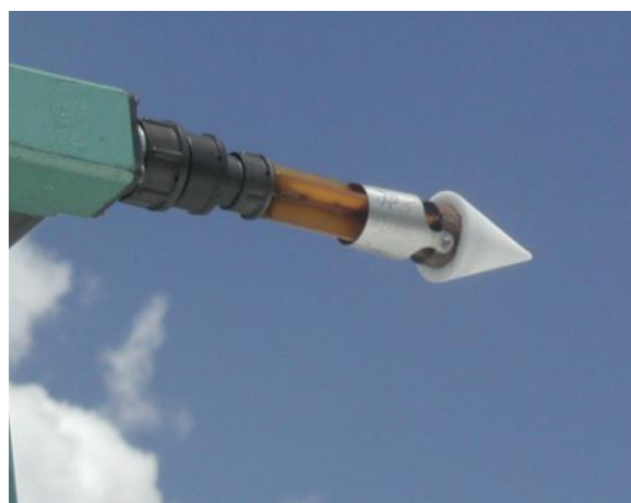
Рисунок 3.1.3 - Размещение датчика ВДТ на самолете-лаборатории Ан-26.
