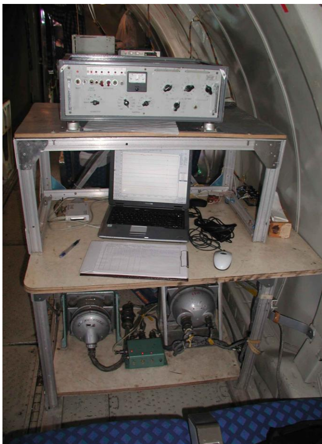
Рисунок 3.1.2 - Внешний вид аппаратуры в салоне самолета-лаборатории Ан-26 (рабочее место оператора)
