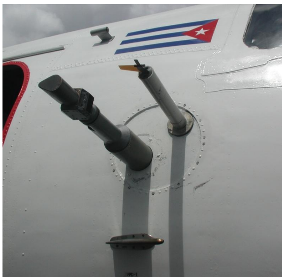
Рисунок 3.1.4 – Датчик измерителя водности облаков конструкции Невзорова и приемник полного давления ППД-1
