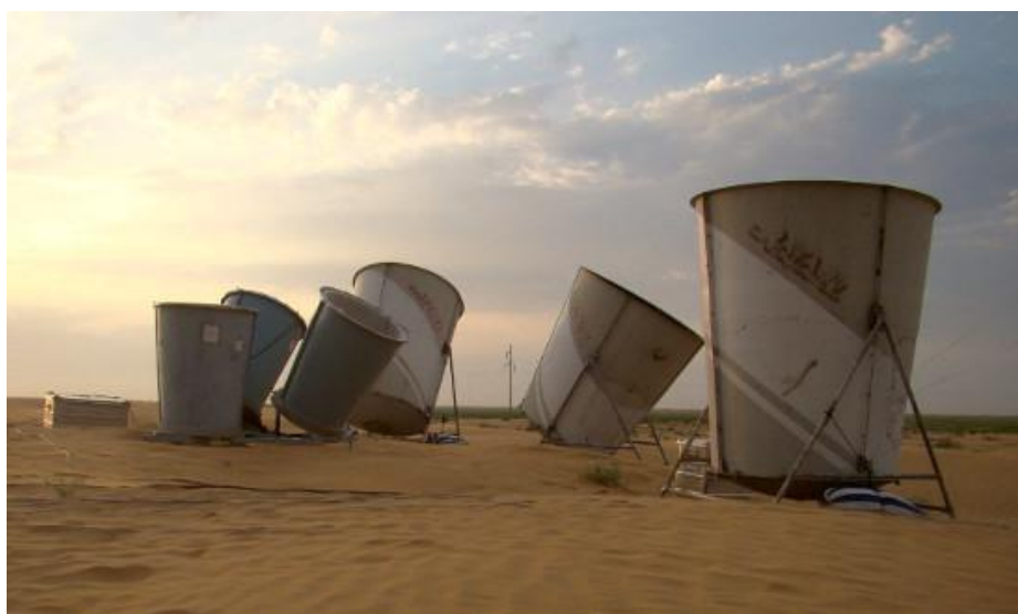
Рис. 2.10. Содар и минисодар в песках Калмыкии в процессе сборки. 2016 г.
