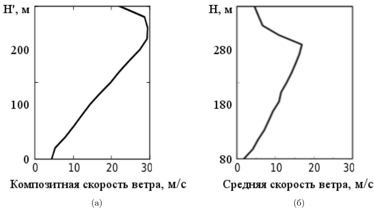
Рис. 4.4. Сопоставление вертикальных профилей скорости ветра, полученных методом композитного осреднения (а) и осреднения по времени (б). ЗНС, 29.01.2010.
